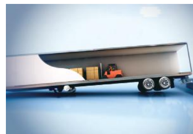
Collasso del carrello di sostegno
